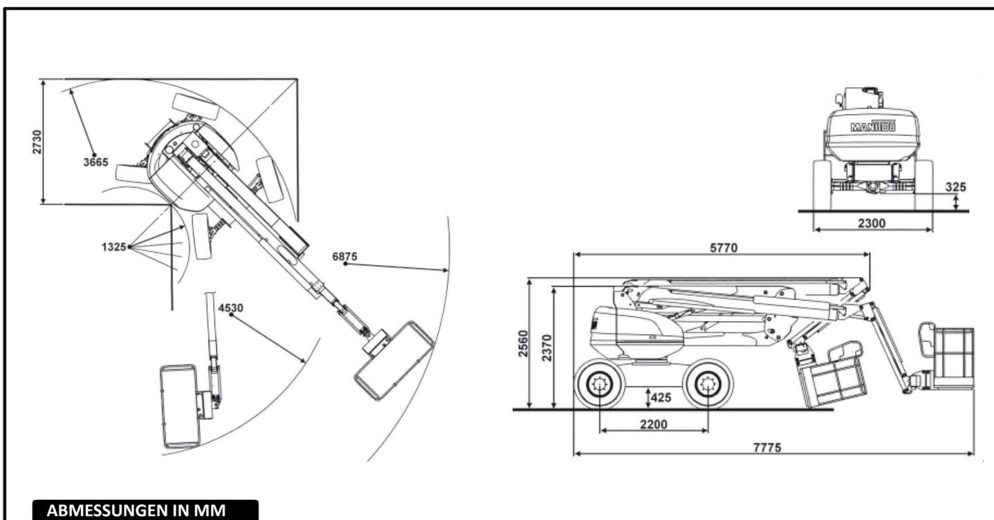
ABMESSUNGEN IN MM
