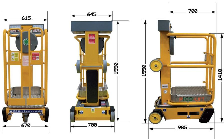
ABMESSUNGEN IN MM
